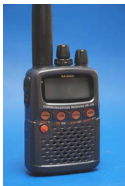
Empfänger zum Schnüffeln au- ßerhalb des geschirmten Raumes
